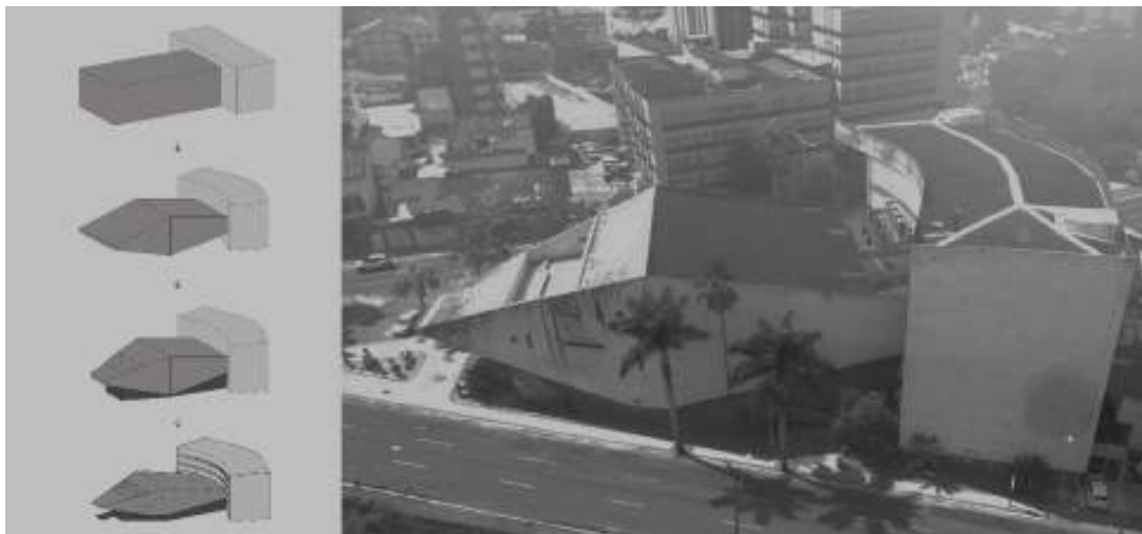
Figura 16: Esquema concepção volumetria do TMSC
