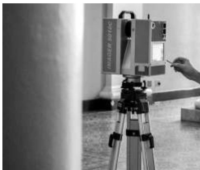
Figura 4: Laser 3D terrestre Z+F Imager 5010C com câmera de sistema giratório para captura esférica.
