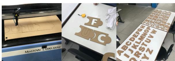
Figura 04 – Letras sendo recortadas no bloco CW
