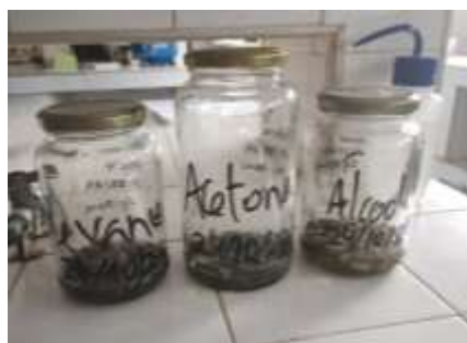
Figura 12 – Extração da essência do eucalipto usando Hexano, Cetona e Álcool.
