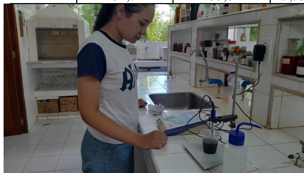
Figura 9 – Aferição do pH do Chorume coletado a partir da compostagem dos resíduos de poda de árvores e da jardinagem do CFP/UFCG, após 90 dias de início do experimento.
