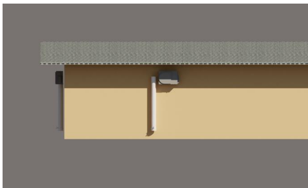
Figura 7 – Coleta individual da água gerada pelos aparelhos de ar-condicionado
