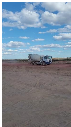
Figura 1 – Trânsito de caminhões e máquinas pesadas que causam a vibração do solo.
