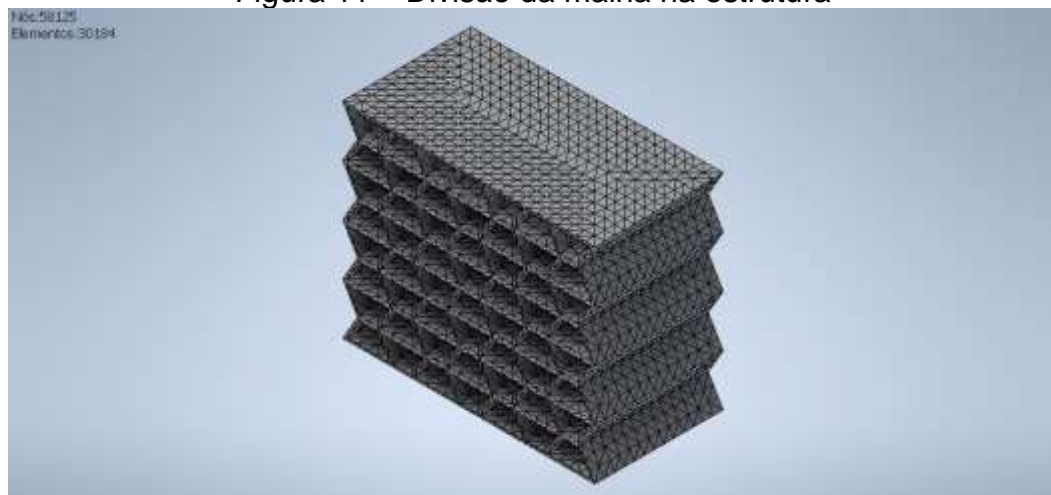
Figura 11 – Divisão da malha na estrutura
