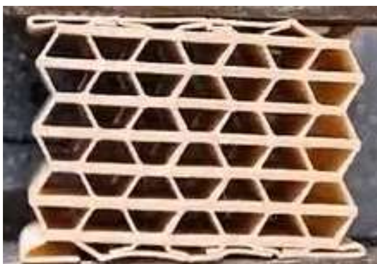
Figura 15 – Rompimento das células superiores e inferiores da estrutura
