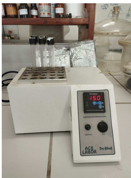
Figura 5- Tubos de ensaio colocados durante 2 horas a 150°C no Bloco Digestor de Dry-Block.
