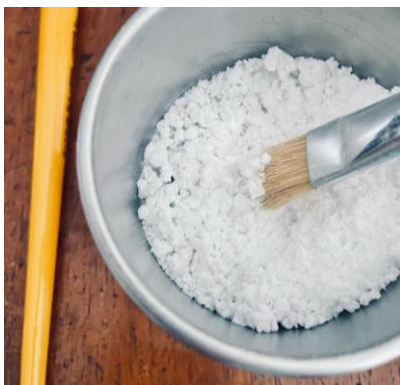
Figura 2. Alumina após o processo de combustão
