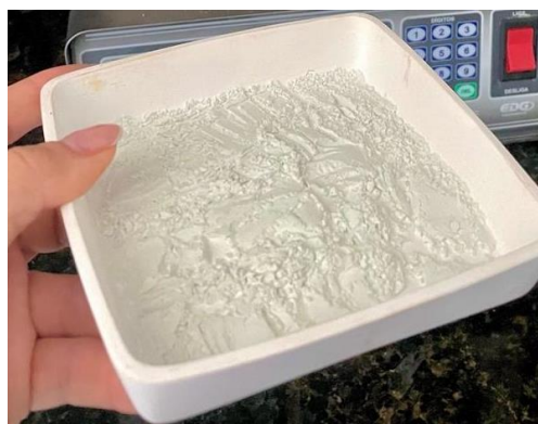
Figura 3. Catalisador de Mo/ \alpha -Al 2 O 3 processo de calcinação.
