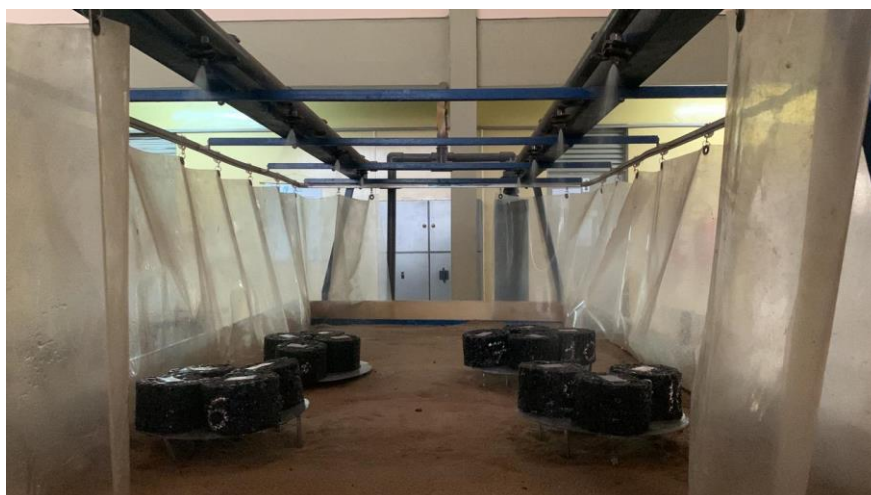
Figura 14 – Simulador de ciclos de chuva (Bloco CR)
