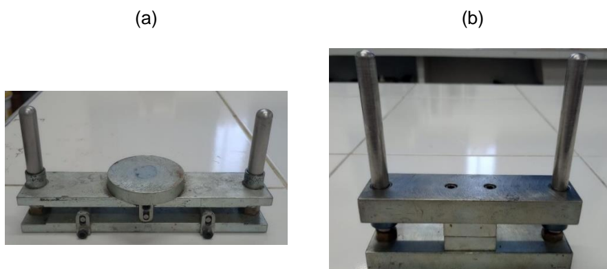
Figura 6 - Dispositivos de carga para tração na flexão (a) e tração por compressão diametral (b).
