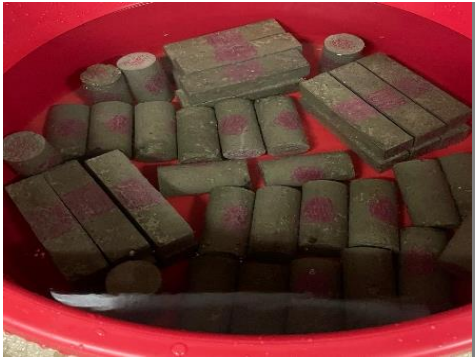
Figura 3 - Corpos de prova submersos em água para cura.
