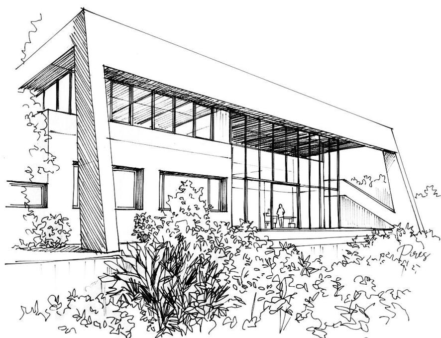
Vista da casa e sua solução brutalista, despertando interesse a solução estrutural do pórtico com vão de 21m que marca a volumetria da obra, com seus pilares trapezoidais.
