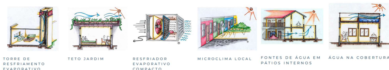
Figura 8 – Aplicações de resfriamento evaporativo sugeridas para o clima de Sousa - PB
