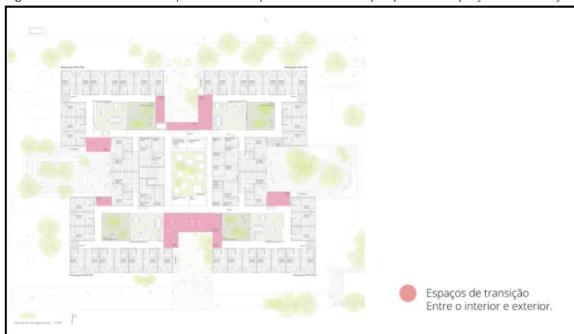
Figura 12: Planta baixa do pavimento superior com destaque para os espaços de transição.
