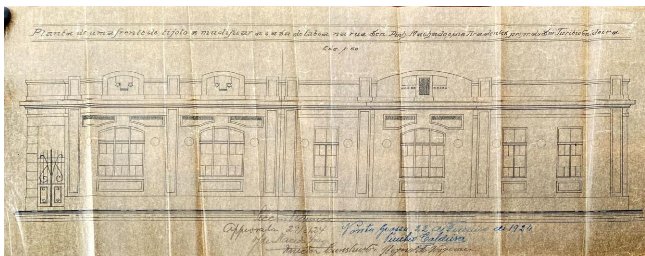
Figura 21: Projeto de uma fachada em alvenaria para uma casa de madeira
