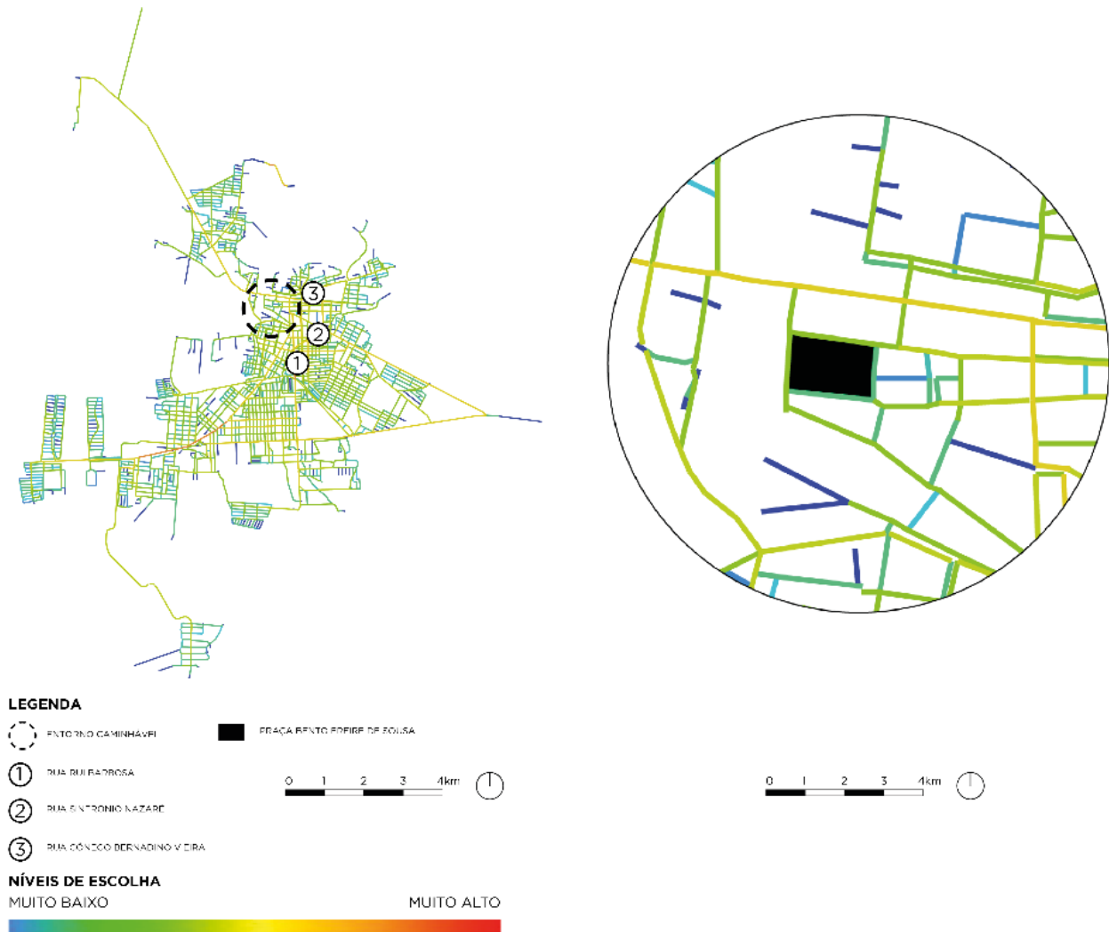
Figura 6: Mapa de escolha angular normalizada (NACH) global de Sousa com recorte ampliado do entorno caminhável (500 metros) da Praça Bento Freire de Sousa
