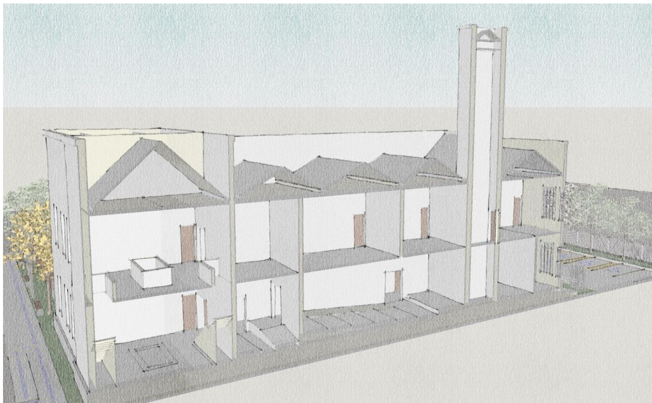
Figura 6: Cortes Perspectivados, seções Longitudinal e Transversal. .
